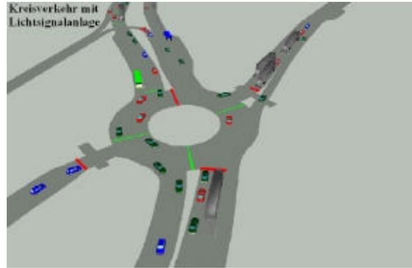
Abb.3: Kreisverkehr mit Lichtsignalanlage und Busbevorzugung
